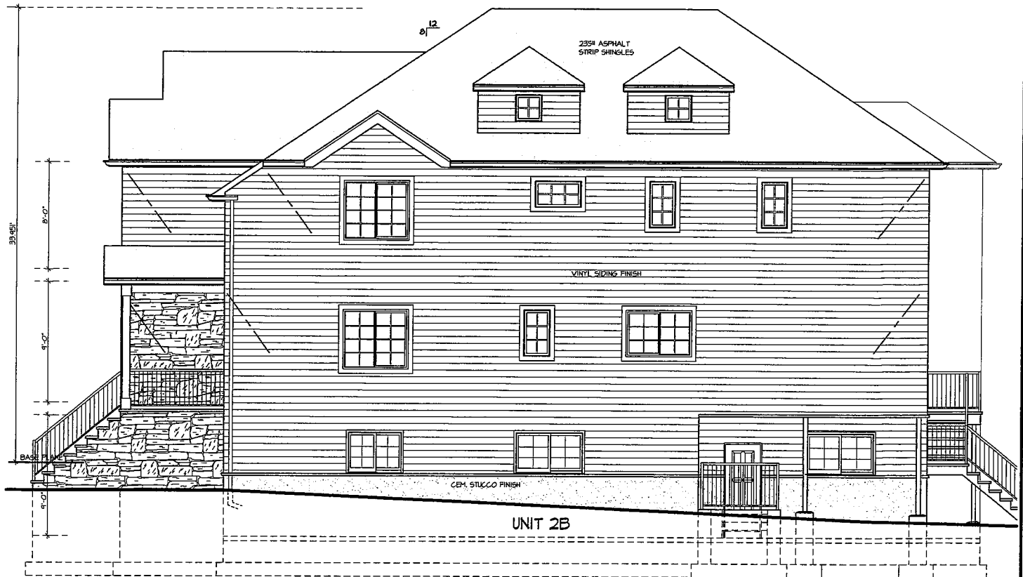
RIGHT SIDE ELEVATION BLDG. # 2
